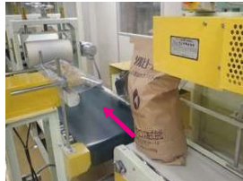
① 袋がコンベアで流れてくる
