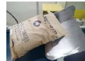
④ 「受け板」が回転し、コンベアに対して袋を真っ直ぐに寝かせる
